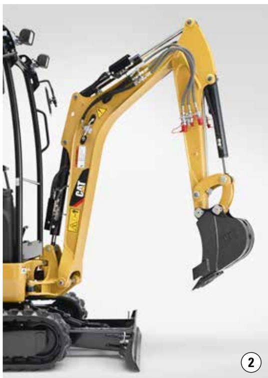
I collegamenti a distacco rapido "pronti all'uso" sono dotati di serie di un accumulatore e contribuiscono a rendere le operazioni di rilascio e sostituzione delle attrezzature rapide ed agevoli. Situati in prossimità dell'attrezzatura, riducono la lunghezza dei tubi flessibili e prevengono i danni potenziali.
